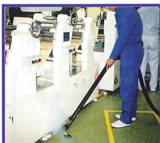
● 排水設備のない場所の機械の下や通路を高温スチーム+ブラシで脱脂洗浄、同時回収。
